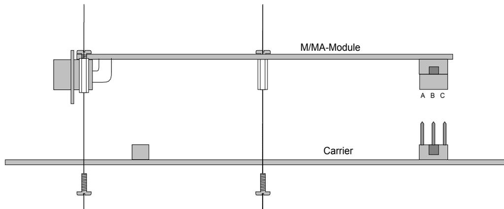
**Figure 3-1, M-Module Installation**
